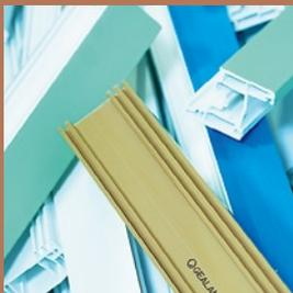
Profilabschnitte, die bei der Produktion von Kunststoff-Fenstern entstehen, sowie PVC-Material von Altfenstern werden gesammelt (Abb. links). Mit Hilfe des Coextrusionsverfahrens werden daraus neue Profile mit Recyclingkern hergestellt (Abb. rechts).
